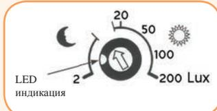
Первая часть шкалы (около 2-20LUX) позволяет точную установку чувствительности для типичных сумерек. Во второй части шкалы (20-200 LUX) вращение регулятора позволяет регулировать чувствительность устройства в более высоком световом диапазоне.
